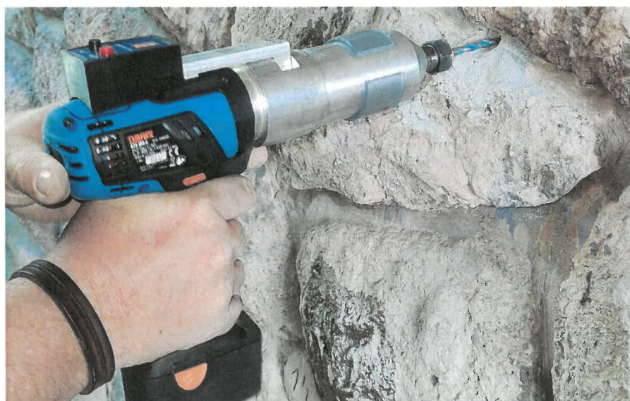
Obr. 9: Ověření pevnosti malty v ložných spárách kamenného zdiva pomocí zkušebního zařízení KV-3 (Kučerova vrtačka).
