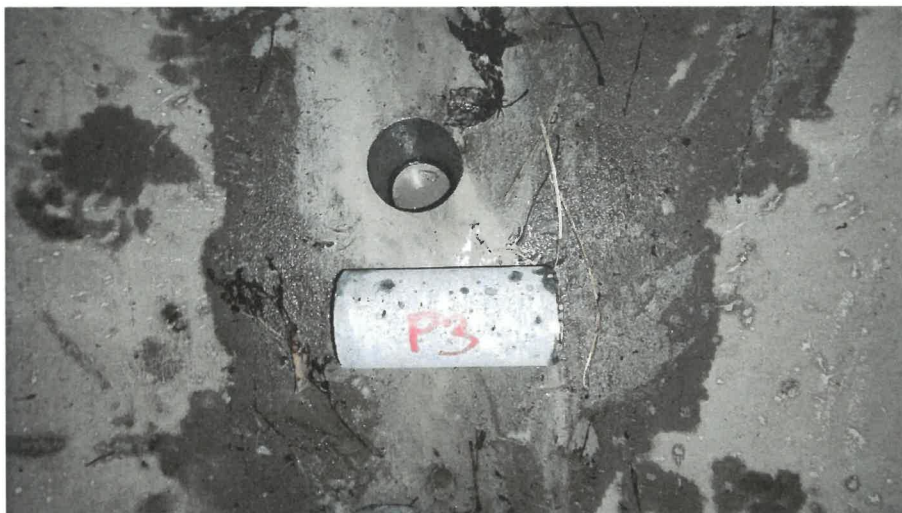
Obr. 10: Pohled na sondu po odběru jádrového vývrtnu P3, který byl odebrán z prefabrikátu propustky (v úrovni dna).
