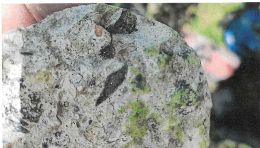
Obr. 8: Kolem některých zrn jsou zřetelně viditelné lemy, to je typické pro alkalicko křemičitou reakci kameniva (ASR).
