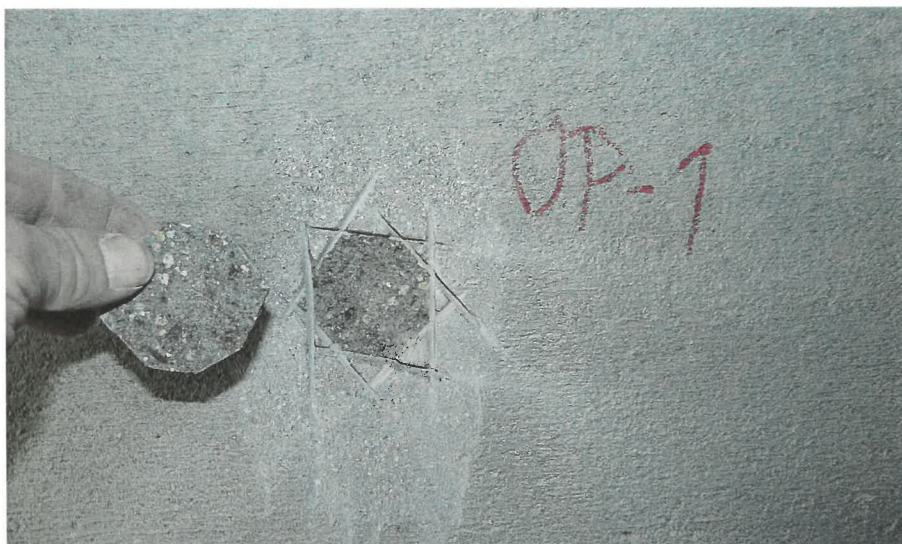
Obr. 13: Místo odtrhové zkoušky O-P1 na vnitřním líci prefabrikátu propustku.
