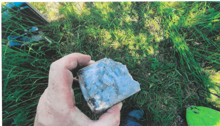
Obr. 7: Část jádrového vývrtu odebraného z konstrukce římsy. Struktura betonu je narušena vlasovými trhlinami, které jsou způsobeny síranovou korozí nebo ASR. Postupně bude docházet k destrukci cementové matrice.
