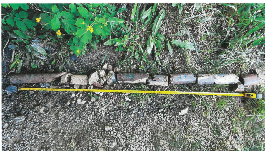
Obr. 8: Pohled na jádrový vývrt 2-5, který byl odebrán z kamenného zdiva opěry mostního objektu. Délka jádrového vývrtu i šířky opěry č. 2 je 1680 mm, u opěry č. 1 je šířka opěry >2500 mm.
