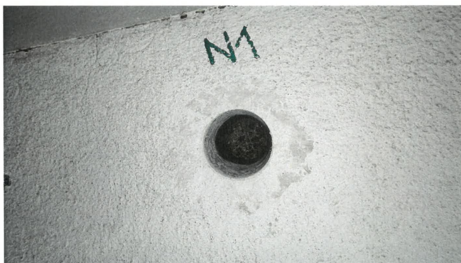
Obr. 18: Pohled na sondu po odběru jádrového vývrtu N-1, který byl odebrán z nosné konstrukce mostního objektu.
