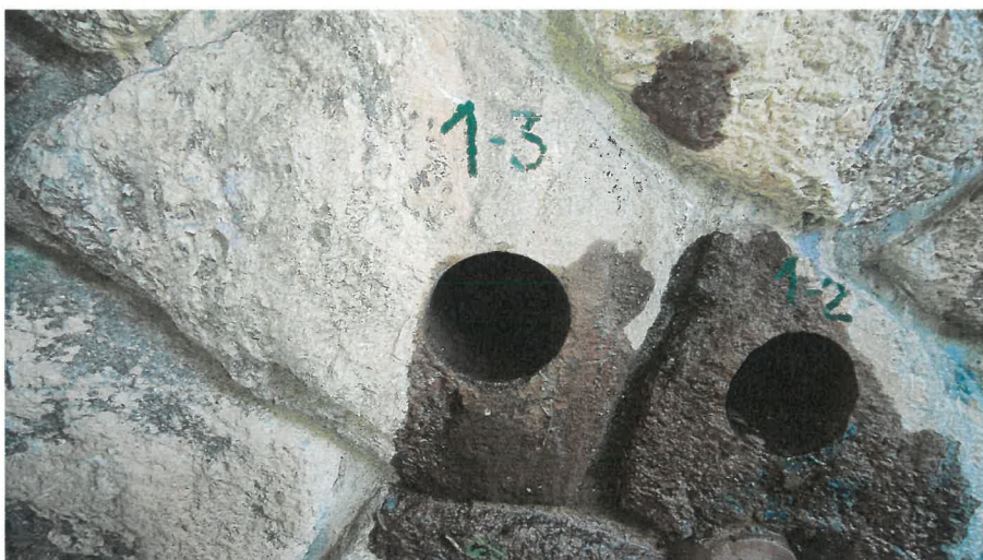
Obr. 4: Pohled na sondu po odběru jádrového vývrtnu 1-3, který byl odebrán z kamenného zdiva opěry mostního objektu.
